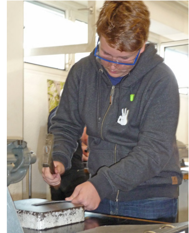
Flachstahl wird getrieben. Aus einem geraden Streifen wird so ein Bogen geformt.
